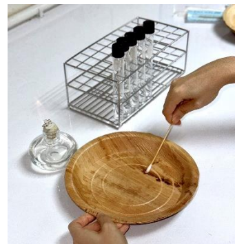
ภาพที่ 2 การทดสอบคุณภาพทางจุลินทรีย์ในผลิตภัณฑ์ ภาชนะสัมผัสอาหารจากธรรมชาติ
