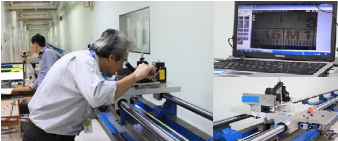
รูปที่ 1 ระบบการสอบเทียบสายเทปมาตรฐานระยะ 50 m
