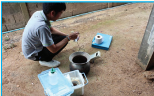
การทดสอบความเป็นกรด-ด่าง ของน้ำทิ้งจากขั้นตอน การย้อมไหม กลุ่มสตรีทอผ้าบ้านบอน อำเภอสำโรง
