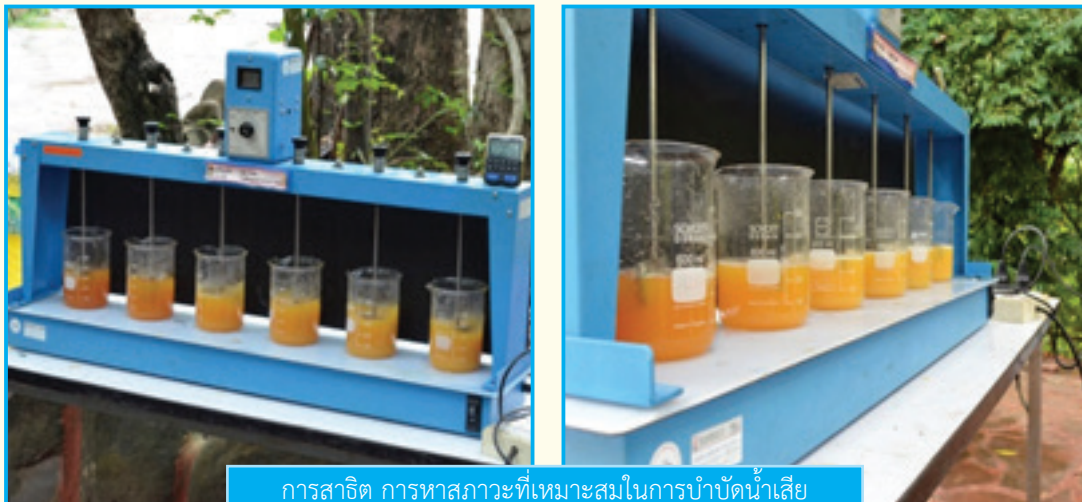
การสาธิต การบำบัดน้ำเสียจากการข้อมสื โดยใช้ระบบบำบัดทางเคมี
