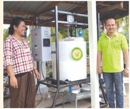
ระบบบำบัดน้ำเสียจากการฟอกย้อม ออกแบบโดยกรมวิทยาศาสตร์บริการ
