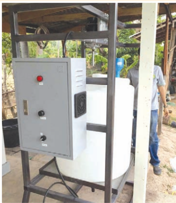
ระบบบำบัดน้ำเสีย โดยการตกตะกอนด้วยสารเคมี
